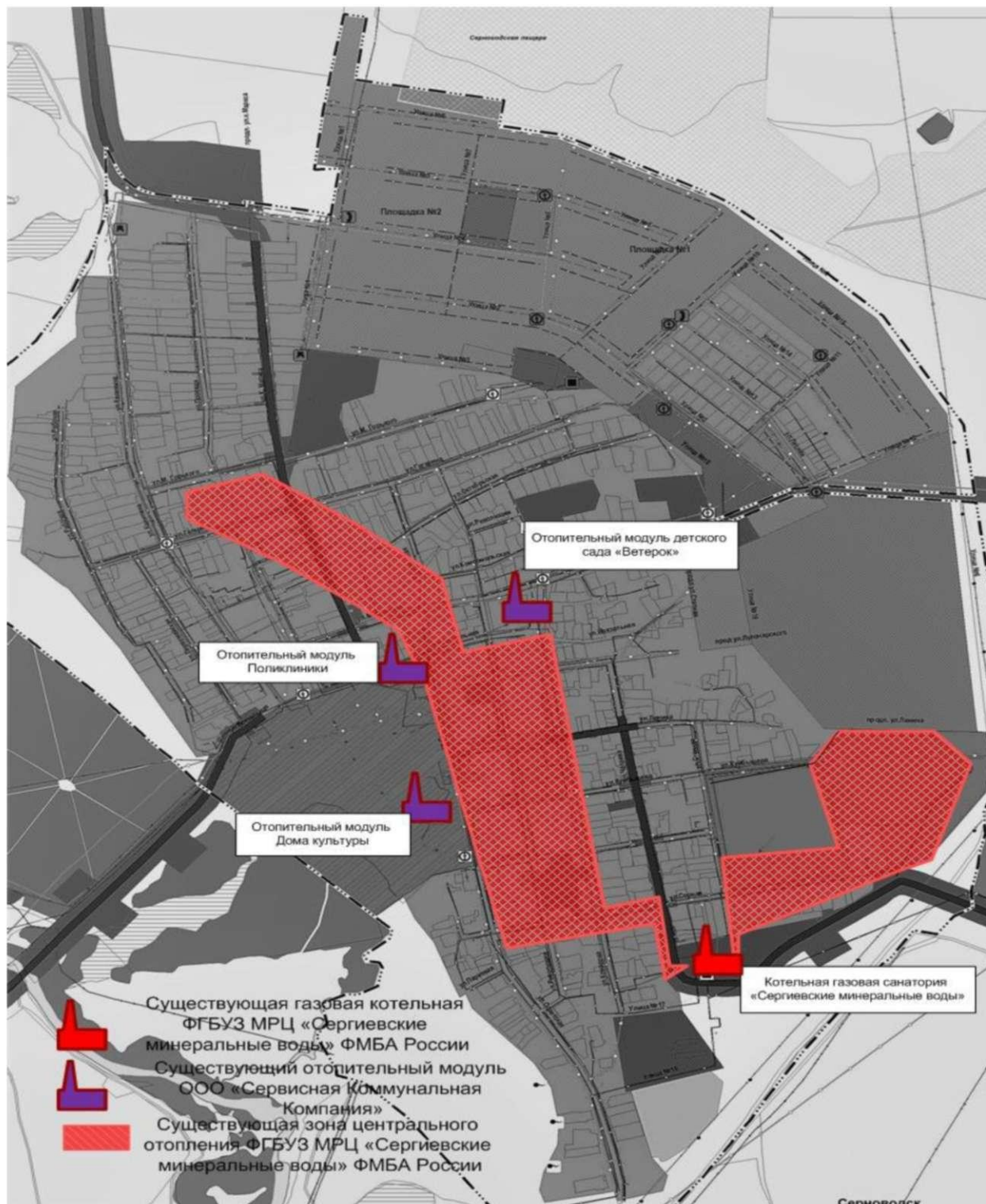
Рисунок 8 – Источники тепловой энергии с. Серноводск
