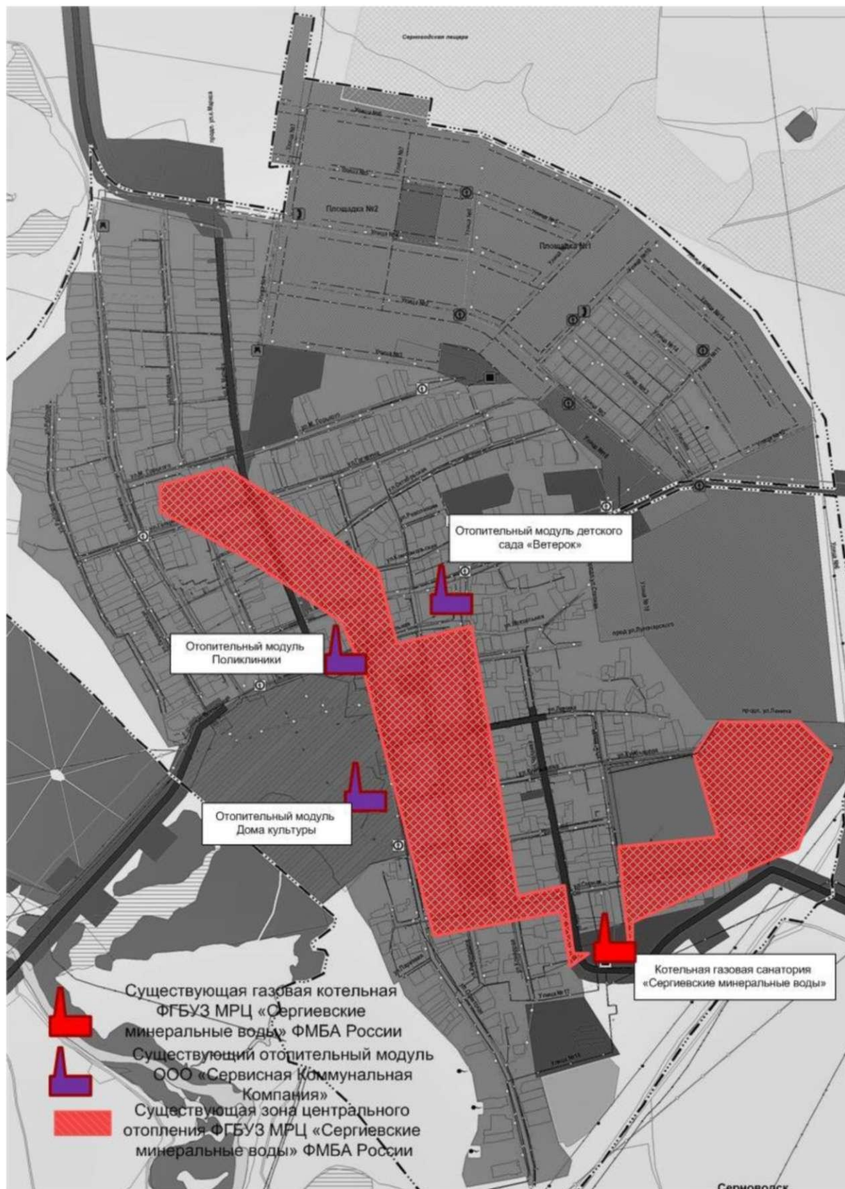
Рисунок 5 – Существующие зоны централизованного теплоснабжения п. Серноводск.
