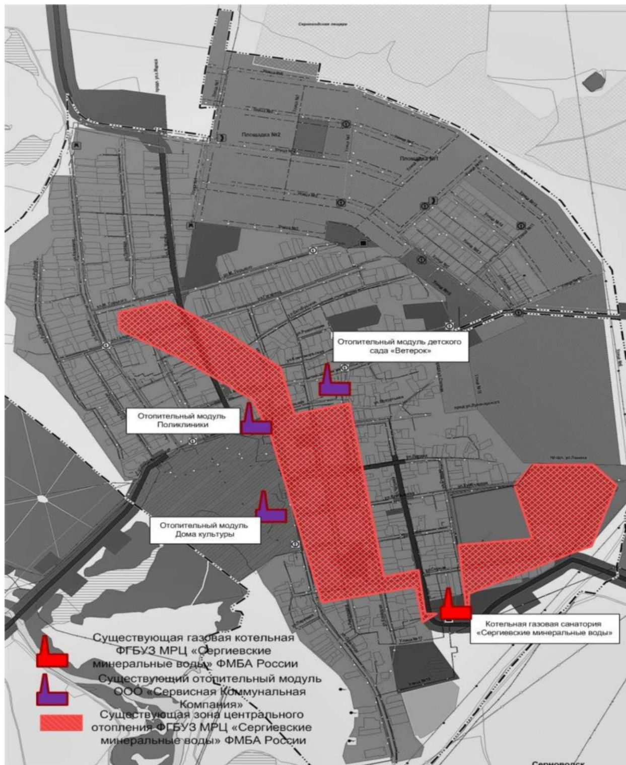
Рисунок 8 – Источники тепловой энергии с. Серноводск
